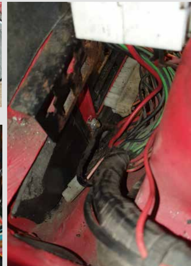
I mitten syns muttern som inte gick att skruva av. Skruven fick kapas med bågfilblad istället...
