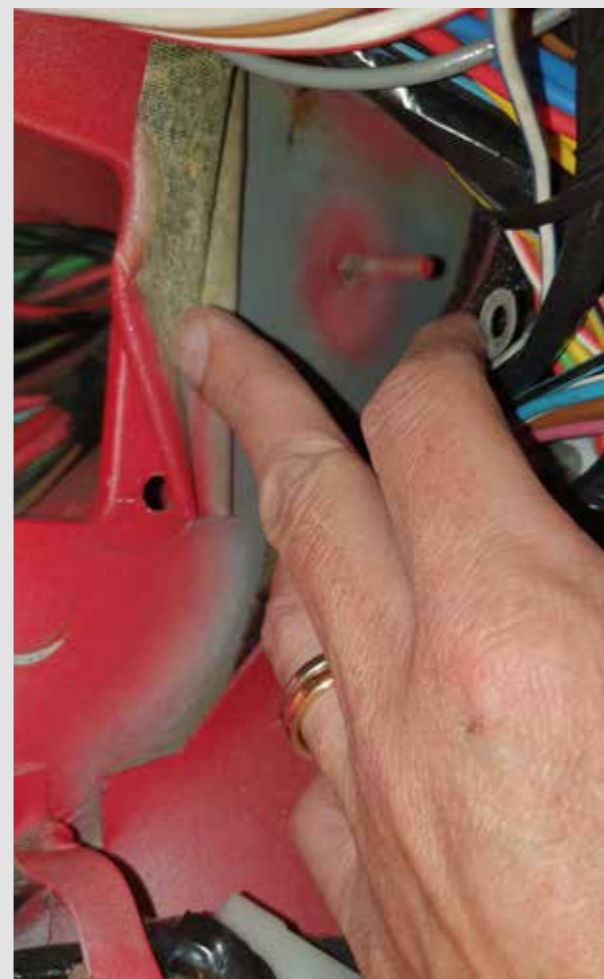
Vid något tillfälle i bilens liv, har jordningspunkten för säkringsboxen fått färg på sig. Jag försökte skrapa bort så mycket jag kunde för att minimera jordningsproblem...
