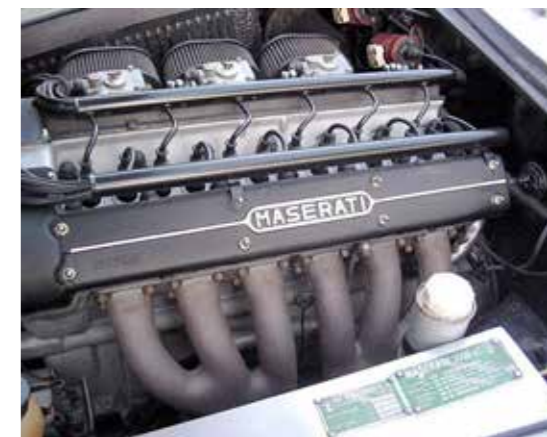
Motorn i 3500 GT 1957 är härledd direkt från 250 men volymen har ökat till 3,5 liter och magneterna har fått ge plats åt en dubbel batteritändning.
