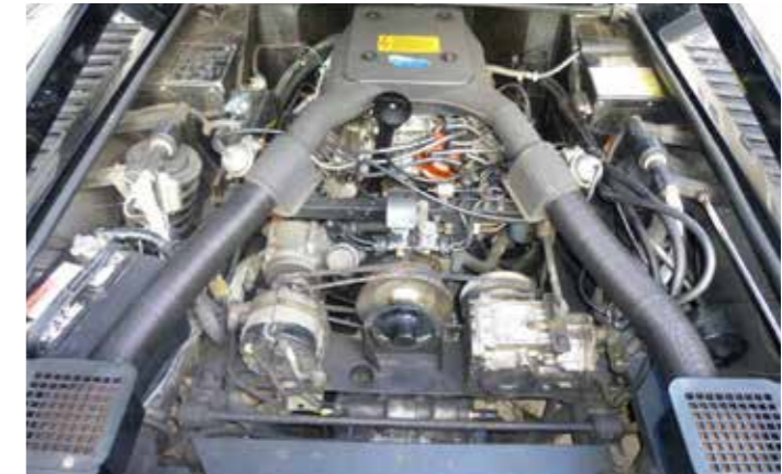
C114 monterad i en Merak i USA-utförande. Drivningen av alla biaggregaten var motorns Akilleshäla men förbättrades efter 1975.
