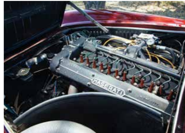
I 3500 GTI, Sebring och Mistral hade motorn indirekt bränsleinsprutning från Lucas. Ett mycket exklusivt system som bara återfanns i dyra bilar.
