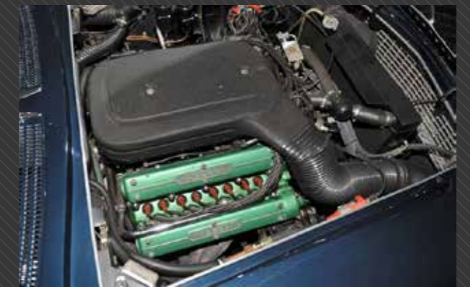
Motorn i Maserati 5000 GT är en något modifierad version av den som användes i racersportvagnen 450 S. Dubbeltändningen har behållits här men togs bort när motorn började användas i Quattroporte. Lustigt nog gjöts topparna på samma sätt men det andra tändstiftshålet borrades aldrig ur. Motorn hängde med i många år och betraktades både som slitstark och driftsäker även om man inte vann några ekonomirallyn med den. Den gröna färgen användes på topparna i alla 5000 GT. Insprutningen kom från Lucas precis som i 3500 GTI.
