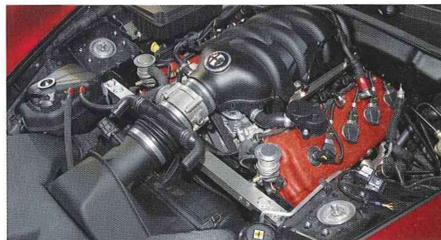
Alfa Romeo 8C Competition delar såväl bottenplatta som drivlina med Maserati Coupé. V8-motorn har utrustats med turbo och har ett Alfa-märke på plenumkammaren. 500 bilar ska byggas och säljas för 162 000.
